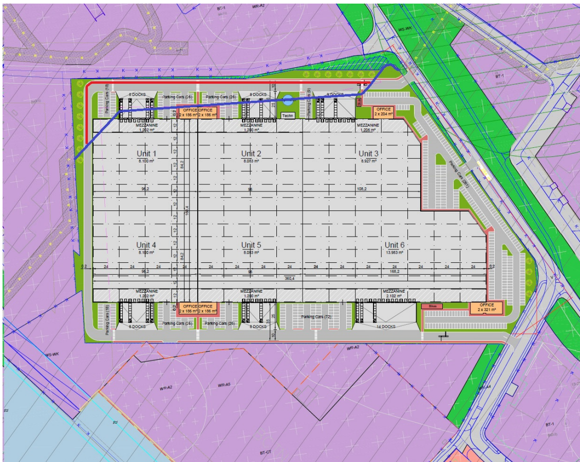
Figuur 2.2 Beoogde situatie met huidige leidingtracé (blauw) en beoogd leidingtracé (rood)
