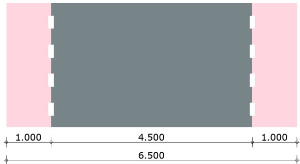
Figuur 21: Wegprofiel derde ontsluiting
