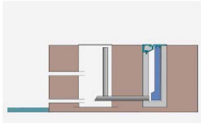
Figuur 4. Weergave werking van de kering (De Ingenieur, 2017)
