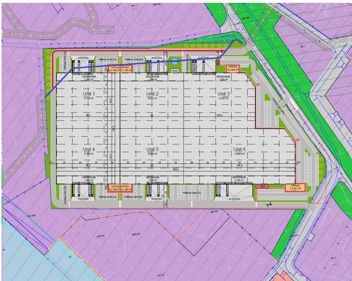
Figuur 2.2 Beoogde situatie met huidige leidingtracé (blauw) en beoogd leidingtracé (rood)
