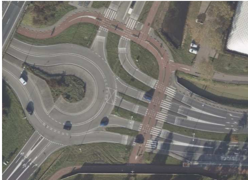
Afbeelding 3.8: Voorbeeld turborotonde met fietsoversteek met tussenbermen
