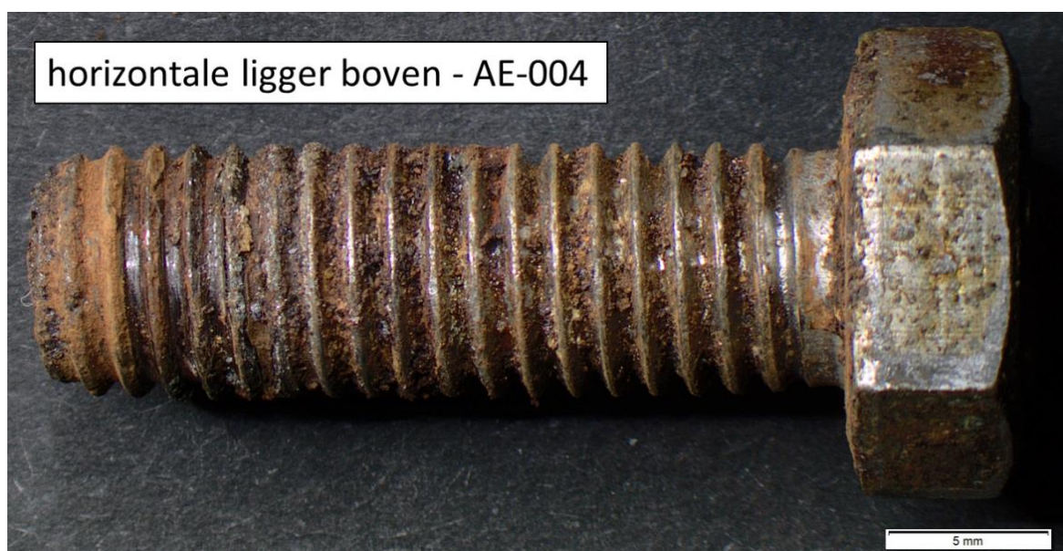
Figuur 17. Een van de bouten uit de horizontale ligger bovenin vak AE-004 tussen de 446 steunen van de verticale ribben naar het betonnen plafond met roestafzettingen over het gehele oppervlak.
