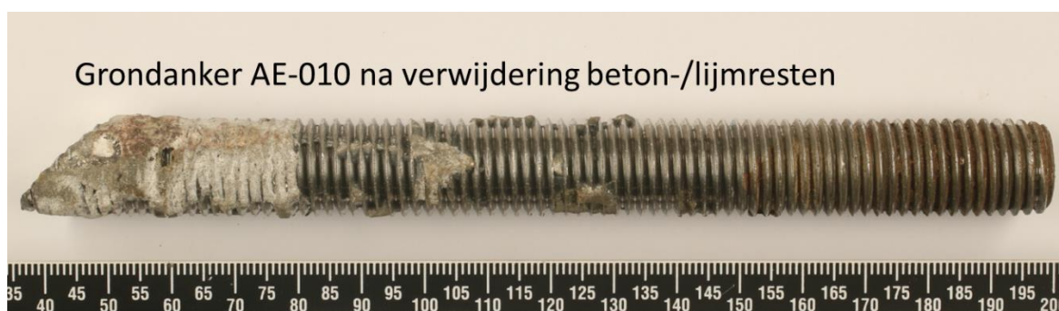
Figuur 18. Het grondanker uit vak AE-010 toonde gematigd bedekt met corrosieproduct. Na verwijdering van de beton- en lijmrestanten toonden het onderliggende oppervlak al na de eerste bedekte draadgang metallisch blank en visueel vrij van corrosieschade.
