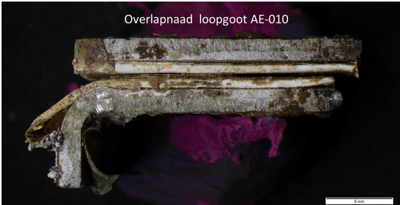
Figuur 21. Een deel van de overlapnaad van de loopgoot in vak AE-010 uitgenomen op de rechter zijde (zie figuur 8) gezien vanaf de zijkant met duidelijk zichtbaar de beide plaatdelen en de daarop geplakte delen folie. Aan de oorspronkelijk blootgestelde randen was enige ruimte zichtbaar tussen plaat en folie (beide delen) waarin zich een bruinachtig product had afgezet. Ook tussen de twee lagen folie was enige ruimte met een afzetting van soortgelijk product. Op de zetrans van de onderliggende plaat was het folie grotendeels losgelaten. (Het paarse materiaal betreft klei en dient om de sample recht te houden voor de foto.)
