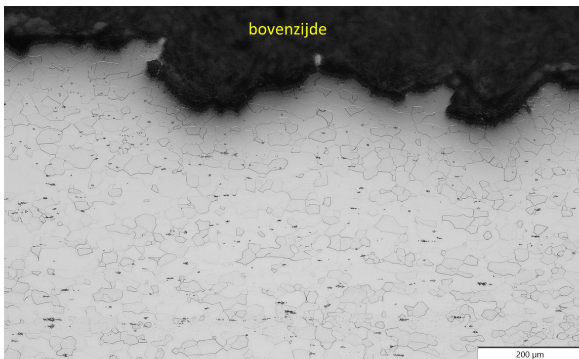
Figuur 23. Foto boven: Zowel de boven als de onderzijde van de horizontale ligger AE-004 toonde significante wanddikteafname door putvorming (de maximale gemeten cumulatieve afname was ca. 0.3 mm op een doorsnede van 1.8 mm). Foto onder: Na etsen met Vilella's reagent toonde zich een microstructuur bestaande uit ferriet met kleine op lijn gewalste groepjes insluitingen (vermoedelijk titaannitriden). Het oppervlak toonden zich putvorming waarbij de microstructuur algemeen aangetast was.
