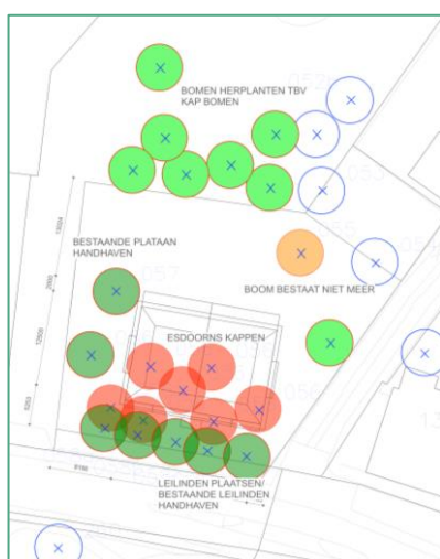
Afbeelding 1.2 Werkzaamheden in het projectgebied
