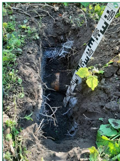
Afbeelding 3.8 Detailfoto beworteling en gresbuis
